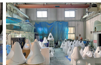
4軸二クロム線切断装置で加工した芯材
