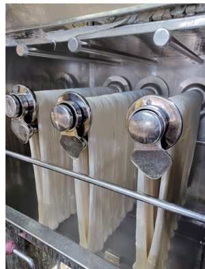
「カセ染色」 染液を噴射する穴の開いた管にカセに巻いた糸の束を掛けて染色
