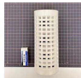
「チーズ染色」 ソフト巻きに使用するボビン ボビンに巻いた状態で染色
