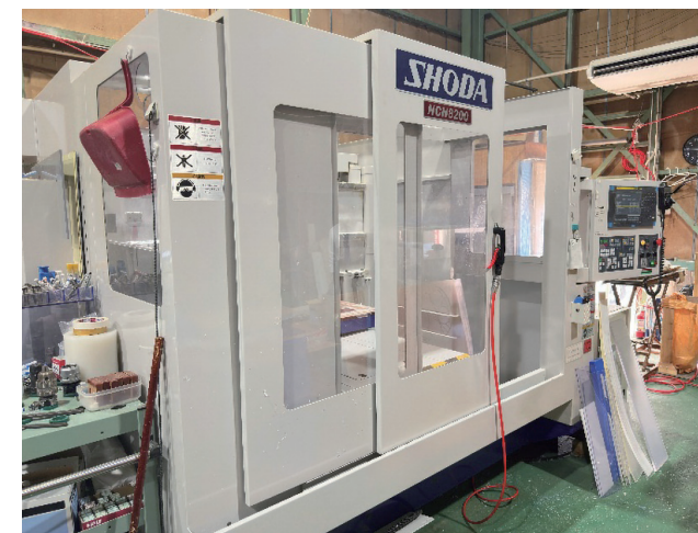
補助事業で導入した設備（NC ルーター）
