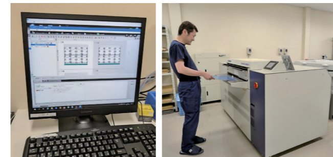
RIPシステムをインストールしたパソコンとサーマルプレートレコーダー刷版出力機
