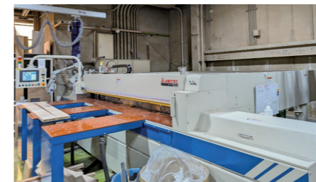
導入したランニングソー（自動切断機） 追加オプションで安全性、スピード、 機能性を追求
