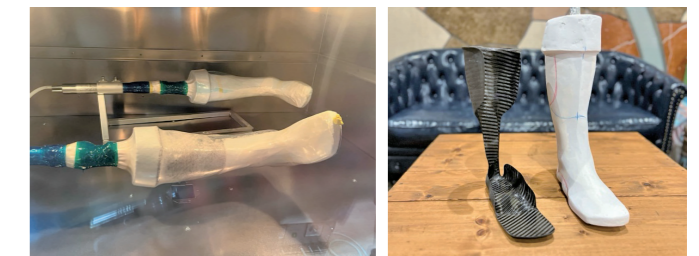
オープン内で加熱中のカーボン装具 カarbon材料を使用した装具の一例
