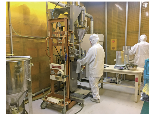
充填システムによる充填作業の様子
